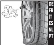
DE Lassen Sie vollständig die Luft aus dem Reifen.
