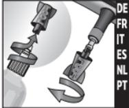
DE Entfernen Sie langsam den Ventilkern mit beiliegendem Werkzeug.
